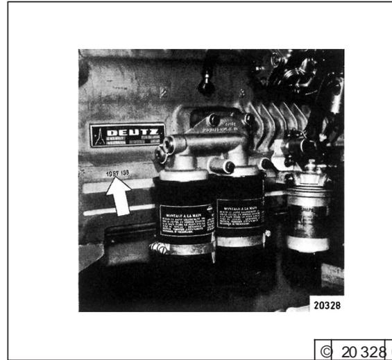
Tyypikilpi **C** on kiinnitetty kampikammioon.
