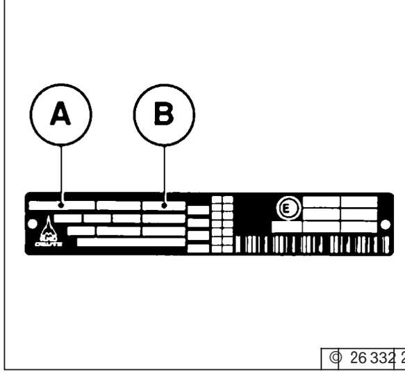
يكون رقم المحرك **B** منقوشا أو مدموجا على بدن المرفق للمحرك وعلى لوحة بيان الطراز للمحرك .
