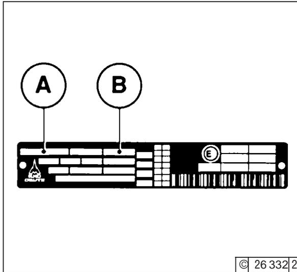
Die Bauart **A**, die Motornummer **B** sowie die Leistungsdaten sind auf dem Firmenschild eingestempelt. Bei der Ersatzteilbeschaffung müssen Bauart und Motornummer angegeben werden.
