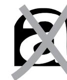
используемые в этом двигателе уплотнения могут содержать асбест. При проведении ремонтных работ обращайтесь внимание на промакированные буквой „a“ запасные части.
